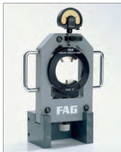
Instrumento de medición del círculo límite FAG MGA 31 para ajustar el juego radial de rodamientos de rodillos cilíndricos con aro exterior desmontable.
