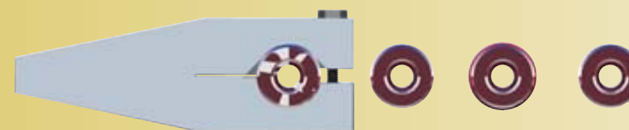
Reconstruir la superficie del Eje con un collar
